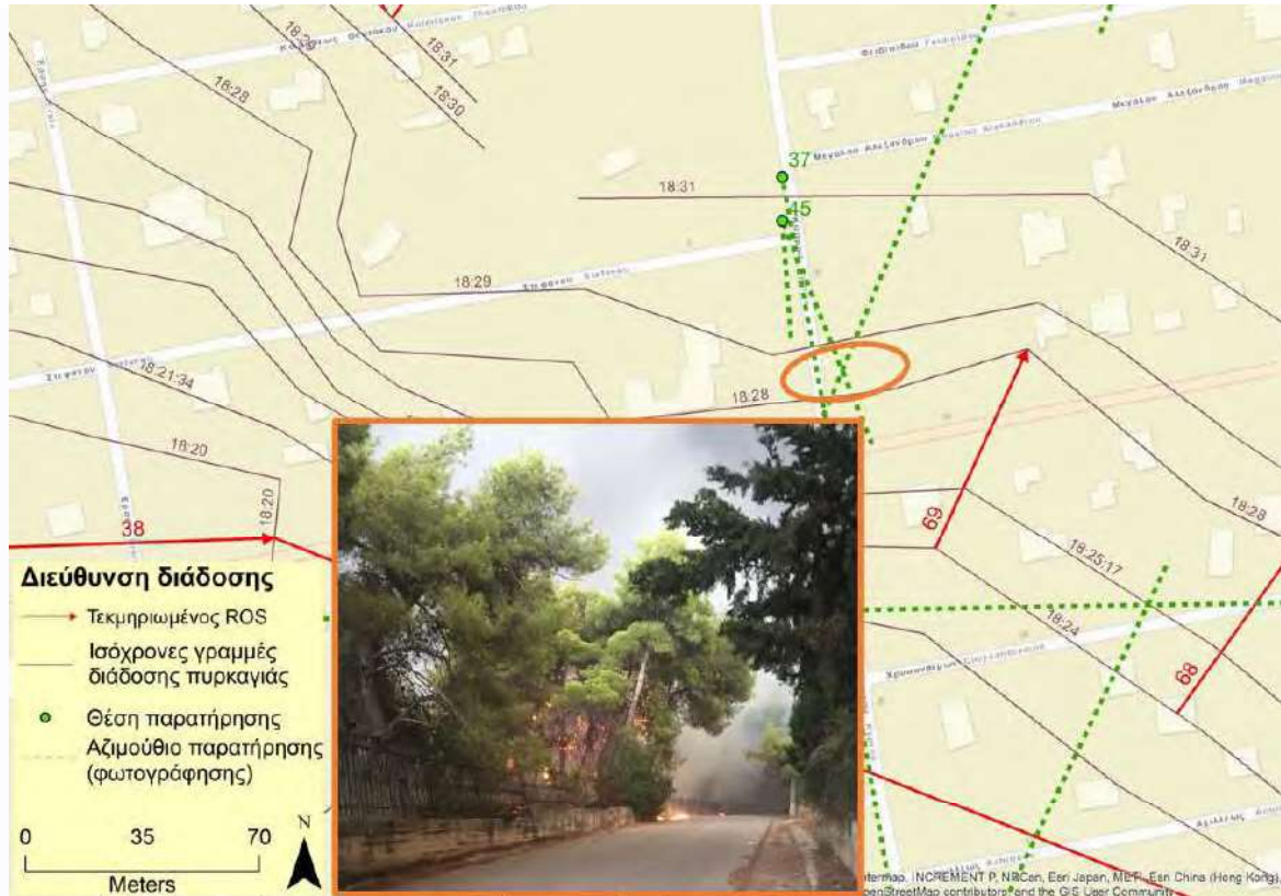
Σχήμα 4. Φωτογράφιση της περιοχής που περικλείεται από την πορτοκαλί έλλειψη (τμήμα της βόρειας πλευράς της πυρκαγιάς, ανατολικά της Μαραθώνος), στις 18:28 από τη θέση 45 (πηγή: Δημήτρης Βακρινός). Οι ζωντανές βελόνες των πεύκων δεν καίγονται χωρίς την επίδραση του ανέμου. Βλέπε, επίσης, διευθύνσεις και ισόχρονες γραμμές διάδοσης της πυρκαγιάς.
